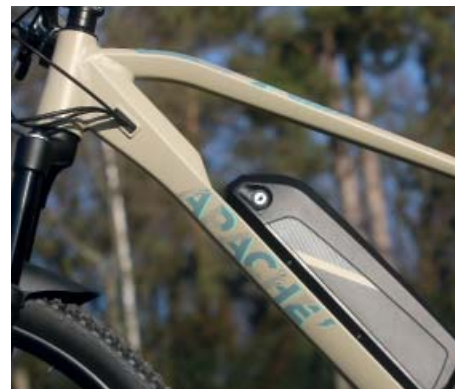
Pevná osa vzadu a přiznaná baterie na spodní trubce rámu.
